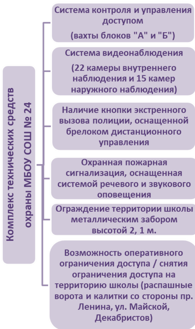
Рис. 6. Комплекс технических средств охраны МБОУ СОШ № 24
